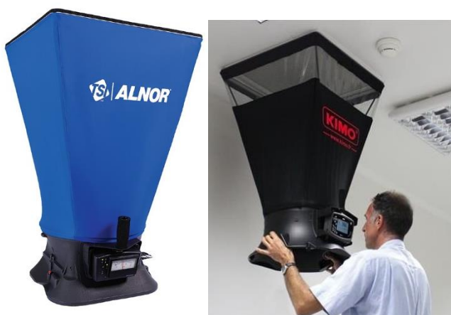
Slika 1. Balometar i način kako se koristi pri merenju zapreminskog protoka vazduha iz ventilacionih sistema.
